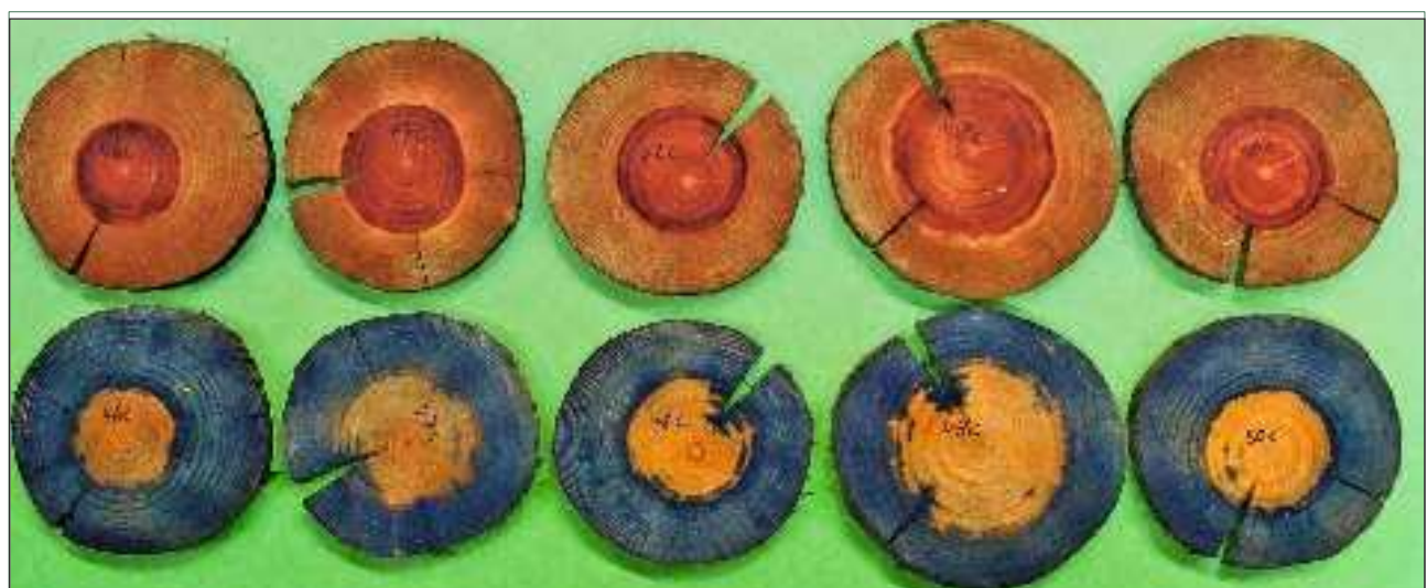
Bild 7: Repräsentative Querschnitte von fünf Pfählen aus dem Fachmarkt mit erfüllter Penetrationsklasse NP5; obere Querschnitte mit roter Kernholzanfärbung und untere Querschnitte mit blauer Kupferanfärbung. Das Splintholz ist vollständig vom Schutzmittel durchtränkt.
