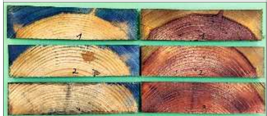
Bild 3: Beispiele für reagenzierte Querschnitte: links blau reagenziertes Kupfer im Splintholzbereich und rechts rot reagenziertes Kiefer-Kernholz
