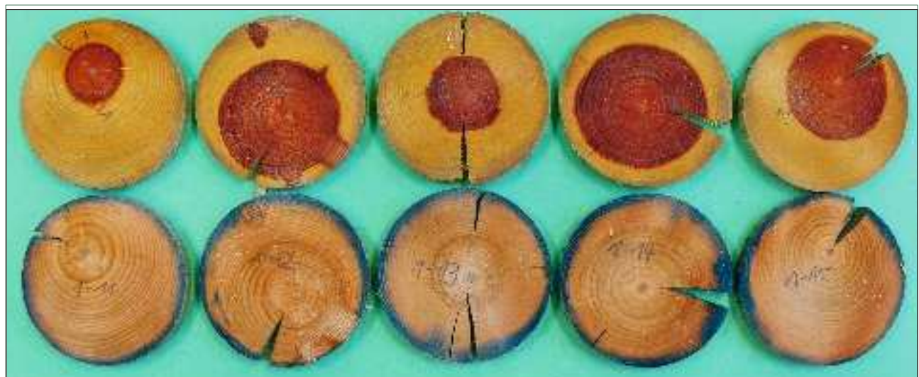
Bild 6: Repräsentative Querschnitte von fünf Pfählen aus dem Baumarkt mit klar verfehlter Penetrationsklasse NP5; obere Querschnitte mit roter Kernholzanfärbung und untere Querschnitte mit blauer Kupferanfärbung. Das Splintholz ist nur marginal vom Schutzmittel getränkt.
