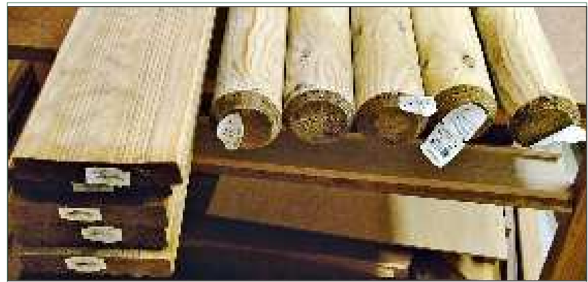
Bild 2: Terrassendielen und Holzpfähle für die Untersuchungen
